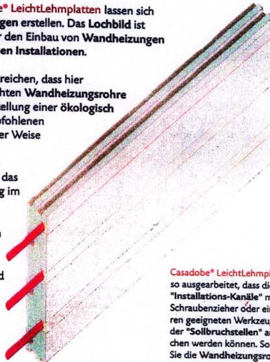
Casadobe® LeichtLehmplatten sind so ausgearbeitet, dass die "Installations-Kanäle" mit dem Schraubenzieher oder einem anderen geeigneten Werkzeug entlang der "Sollbruchstellen" aufgebrochen werden können. So können Sie die Wandheizungsrohre für Ihre Wandheizung ohne grossen Aufwand einbringen.
