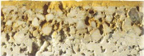
Ergebnis: eine untrennbare, mikroporöse und somit äußerst wasserdampfdurchlässige Einheit zwischen BEECK REINKRISTALLIN und der mineralischen Baustoffoberfläche.
